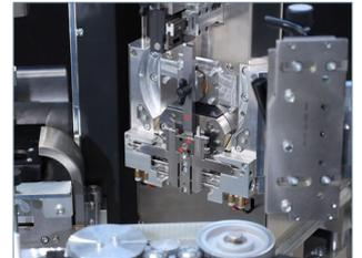
由软件控制的压接力可以与相应的导体横截面相适应，对不同的套圈进行可靠和快速的处理。
